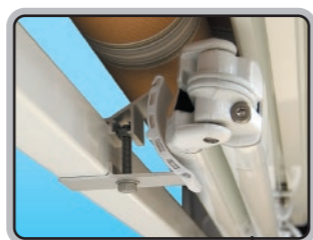
■アームストッパー アーム収納時にアームエルボー部と巻取パイプの接触を防止します。
